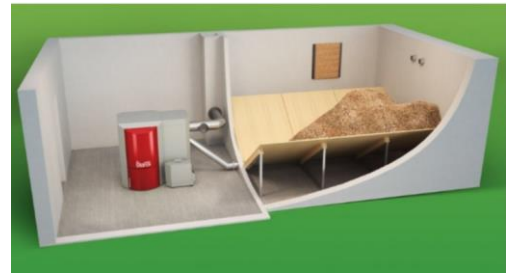
Local dédié avec pan incliné et alimentation par vis sans fin © OKOFEN
