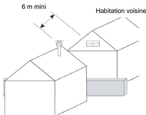
**Distance d'un terminal vertical à un ouvrant ou à une entrée d'air d'une habitation voisine**
