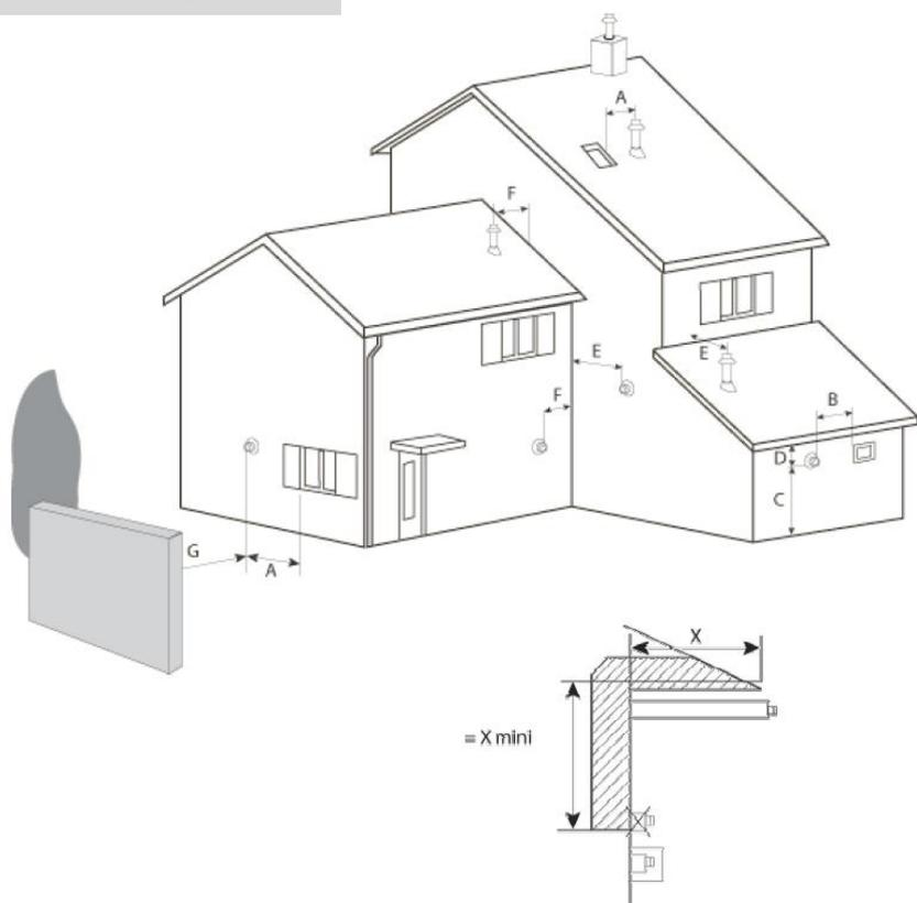
**A.** Distance minimum de l'axe de l'orifice des produits de combustion à tout ouvrant : **2 m**
