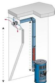
Évacuation des fumées en façade avec conduit coaxial
