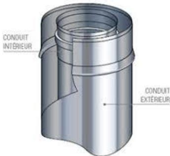
**Conduit coaxial de fumée, permettant l'évacuation des fumées et l'entrée de l'air de combustion avec un seul conduit. L'air neuf est ainsi réchauffé au contact de la canalisation intérieure et augmente de près de 10% (selon l'Ademe) le rendement des poêles à granulés.**
